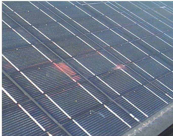
**Figure 28. Mobil Array Module 4 Corrosion**
