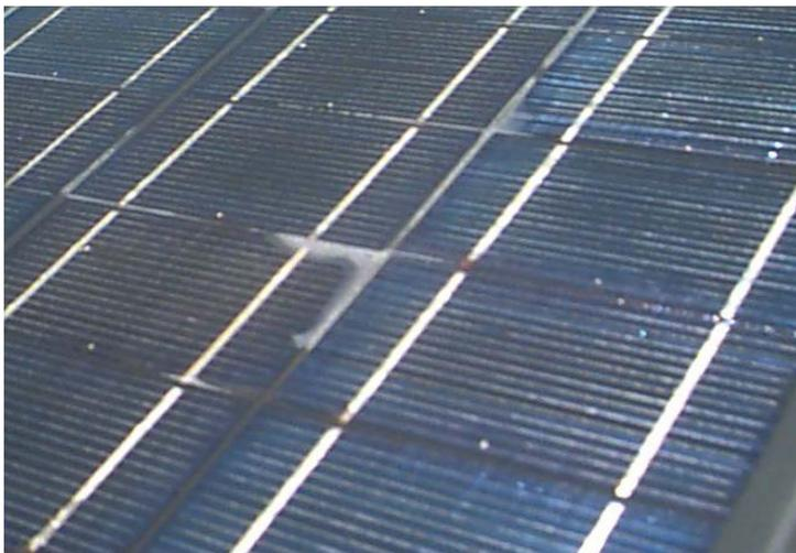
**Figure 29. Mobil Array Module Delamination**
